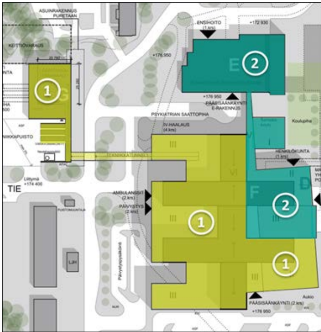
Kuva 2. Hankkeen rakennusvaiheet 1 ja 2.
